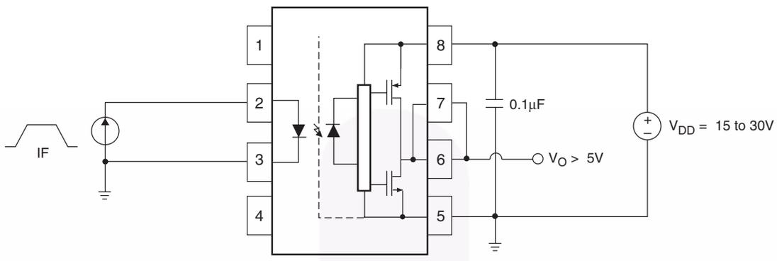
**Figure 26.  $I_{FLH}$  Test Circuit**
