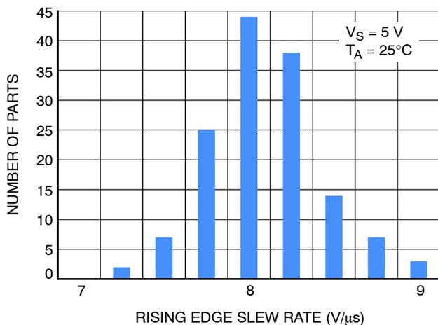
Figure 24. Rising Edge Slew Rate @  $V_S = 5\text{ V}$
