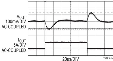
3.3V<sub>IN</sub>, 2.5V<sub>OUT</sub>, 5A TO 10A LOAD STEP, 5A/µs
