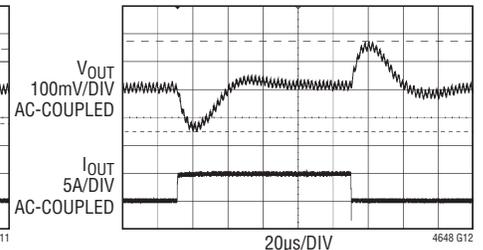
5V<sub>IN</sub>, 3.3V<sub>OUT</sub>, 5A TO 10A LOAD STEP, 5A/µs
