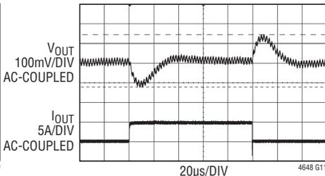
5V<sub>IN</sub>, 2.5V<sub>OUT</sub>, 5A TO 10A LOAD STEP, 5A/µs
