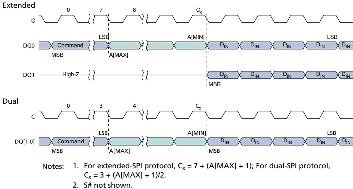
**Figure 39: EXTENDED DUAL INPUT FAST PROGRAM Command**
