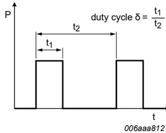
**Fig. 18. Duty cycle definition**
