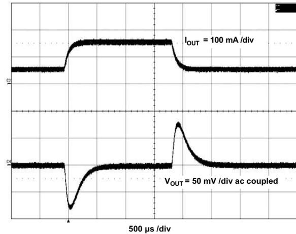
Figure 28. Load Transient
