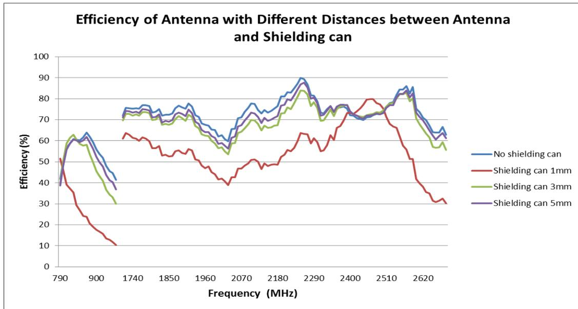
**FIGURE 4.1.2 EFFICIENCY COMPARISON AT 790-960MHz AND 1.7-2.7GHz BAND OF DIFFERENT SHIELDING CAN DISTANCE FROM ANTENNA**
