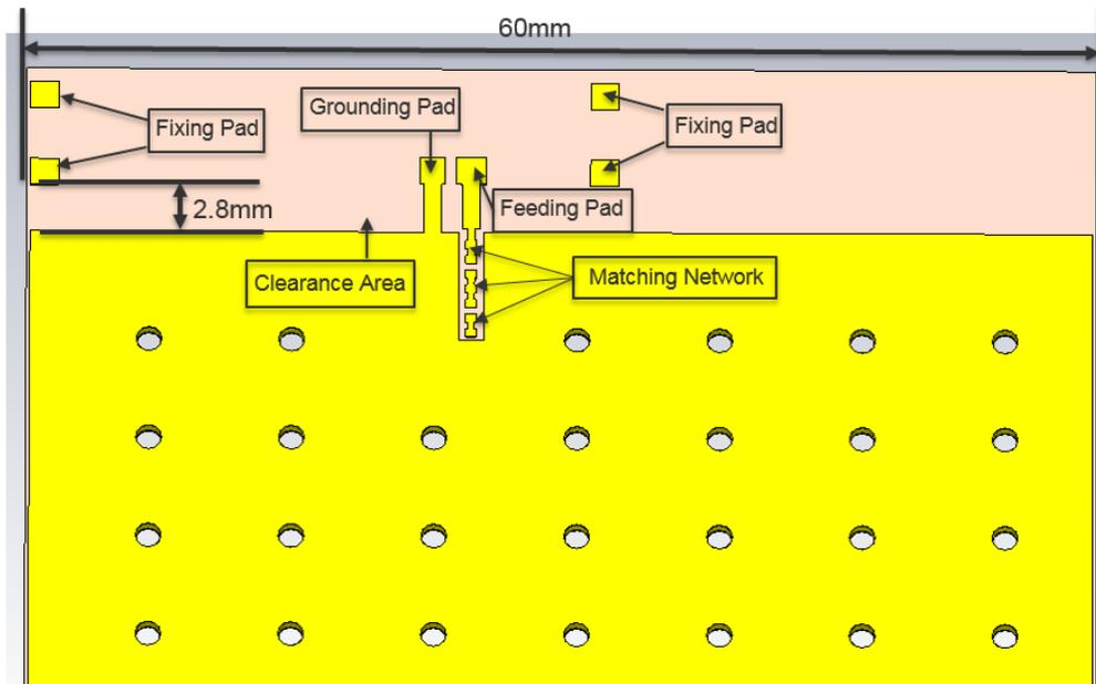
FIGURE 2: RECOMMENDED PCB LAYOUT
