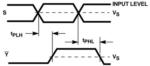
FIGURE 3. SELECT TO OUTPUT PROPAGATION DELAYS (CD74ACT258)
