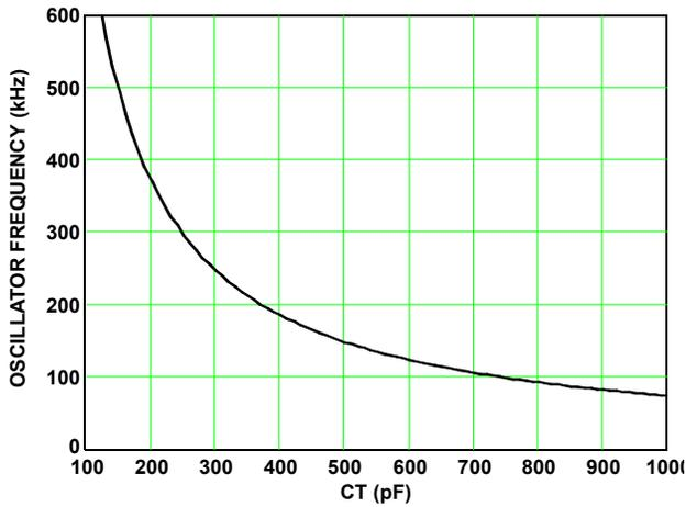
FIGURE 3. CAPACITANCE vs OSCILLATOR FREQUENCY (RTD = 49.9kΩ)
