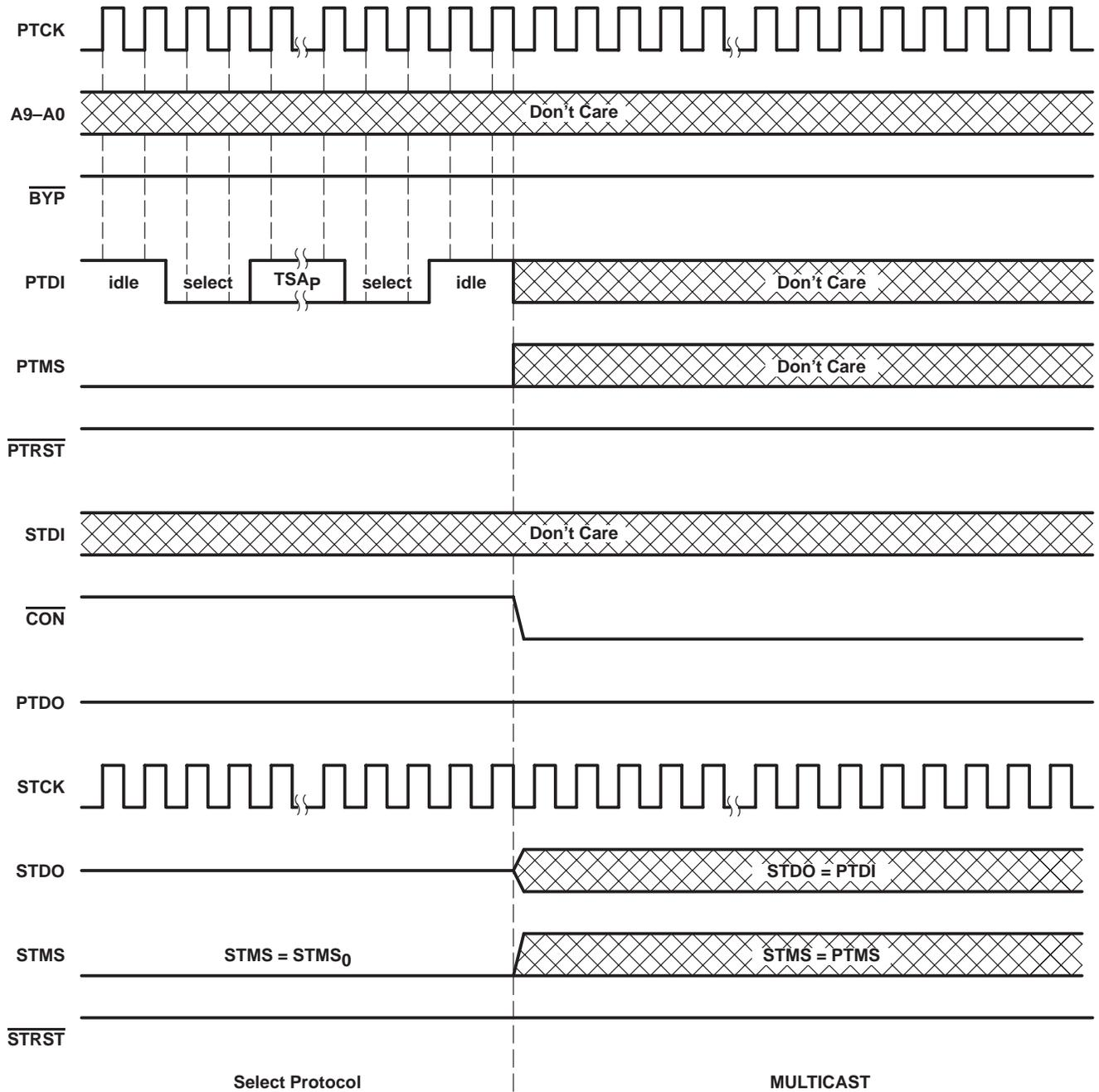
**Figure 15. Shadow-Protocol Timing,**
