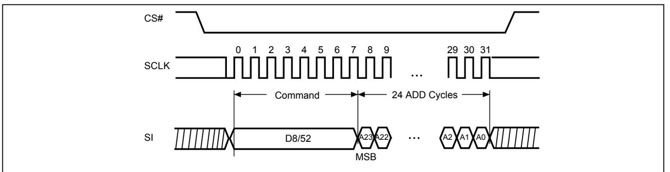
**Figure 27. Chip Erase (CE) Sequence (Command 60 or C7)**
