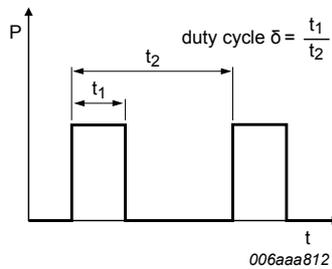
Fig. 23. Duty cycle definition
