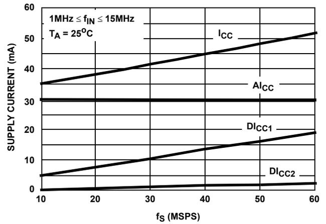
FIGURE 16. SUPPLY CURRENT vs SAMPLE CLOCK FREQUENCY
