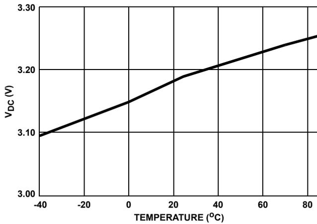
FIGURE 21. DC BIAS VOLTAGE ( $V_{DC}$ ) vs TEMPERATURE
