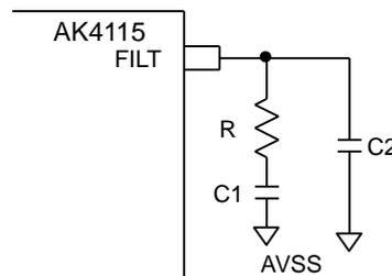
Figure 27. PLL Loop Filter
