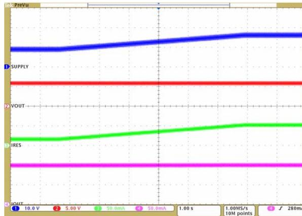
Ch. 1 =  $V_{\text{SUPPLY}}$       Ch. 2 =  $V_{\text{OUT}}$       Ch. 3 =  $I_{\text{P}}$
