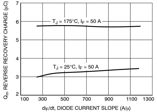
Figure 20.  $Q_{rr}$  vs.  $di_F/dt$  ( $V_R = 400\text{ V}$ )
