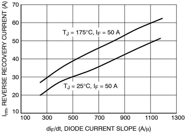
Figure 21.  $I_{rm}$  vs.  $di_F/dt$  ( $V_R = 400\text{ V}$ )
