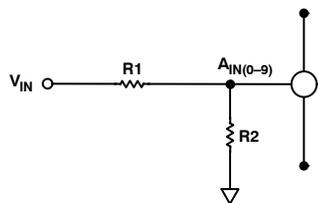
**Figure 27. Scaling A<sub>IN0</sub> - A<sub>IN9</sub>**
