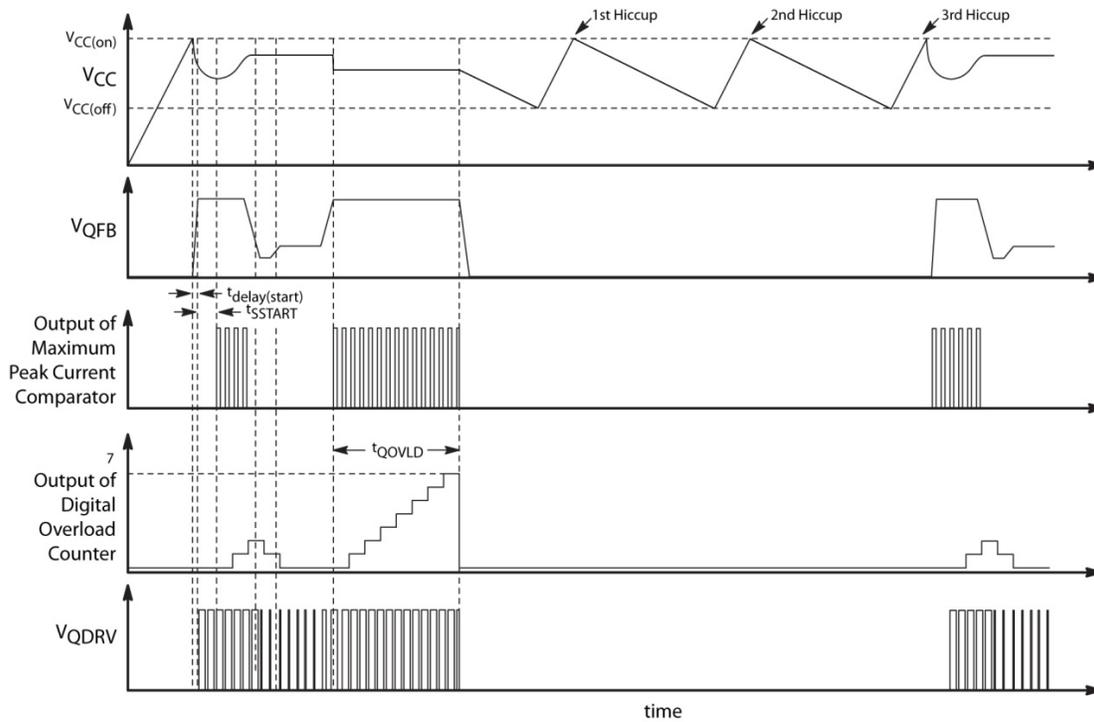
**Figure 23. Auto-Recovery Overload Operation**
