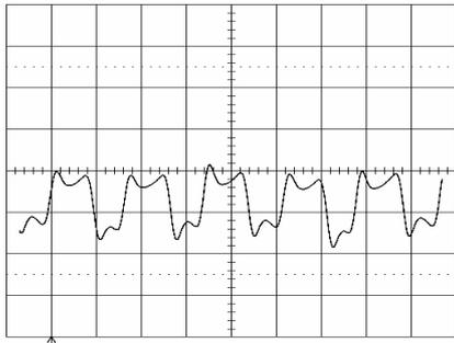
Output voltage ripple (20mV/div.) at:
