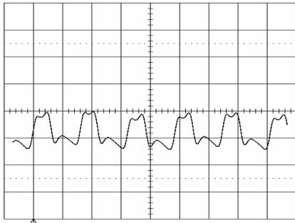
Output voltage ripple (20mV/div.) at:
