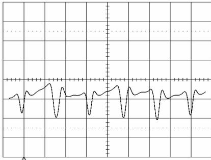
Output voltage ripple (20mV/div.) at:
