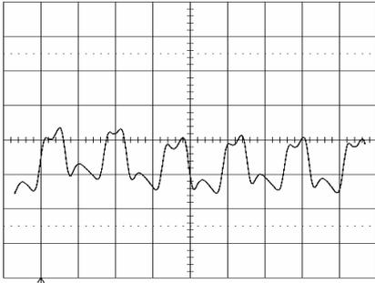
Output voltage ripple (20mV/div.) at:
