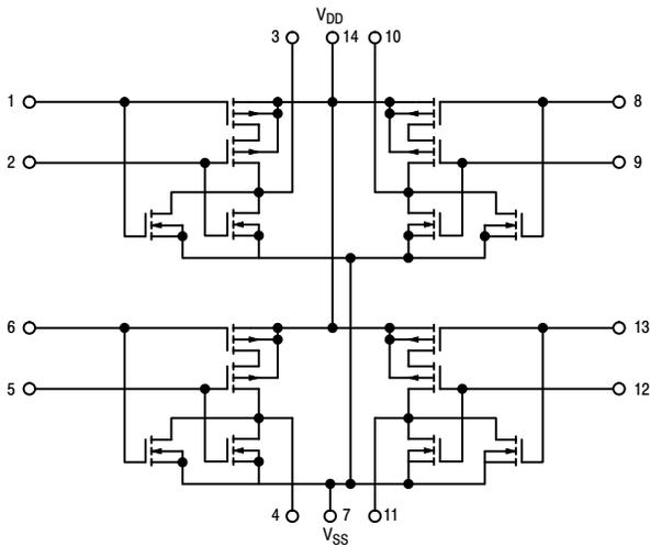
**MC14011UB CIRCUIT SCHEMATIC
