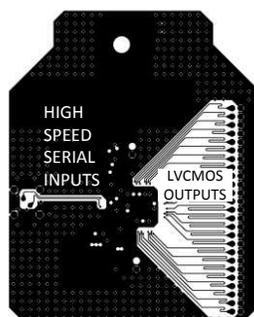
**Figure 35. Example DS90UR124-Q1 EMC Layout**
