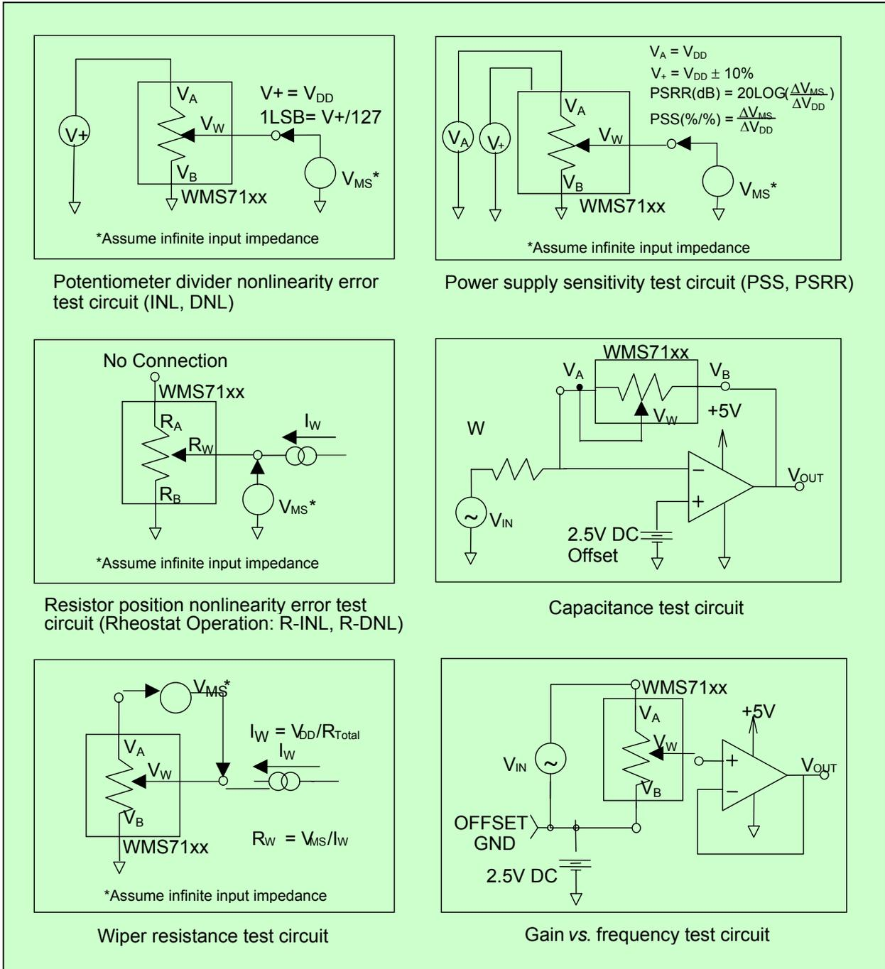
FIGURE 4 – TEST CIRCUITS
