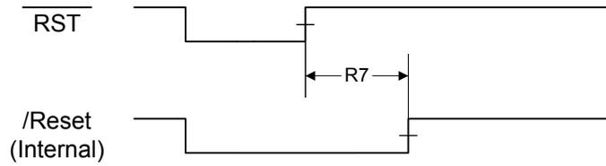
Figure 17-6. Power-On Reset Timing
