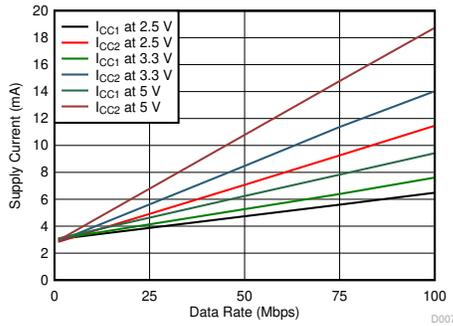
$T_A = 25^\circ\text{C}$        $C_L = 15\text{ pF}$
