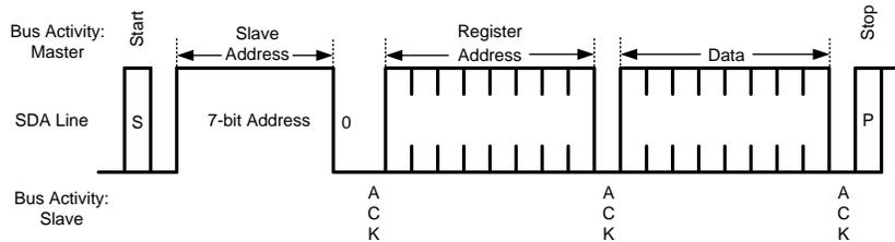
Figure 25. Write Byte
