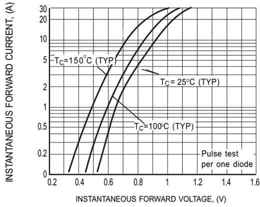
**FIG.1 INSTANTANEOUS FORWARD CHARACTERISTICS**
