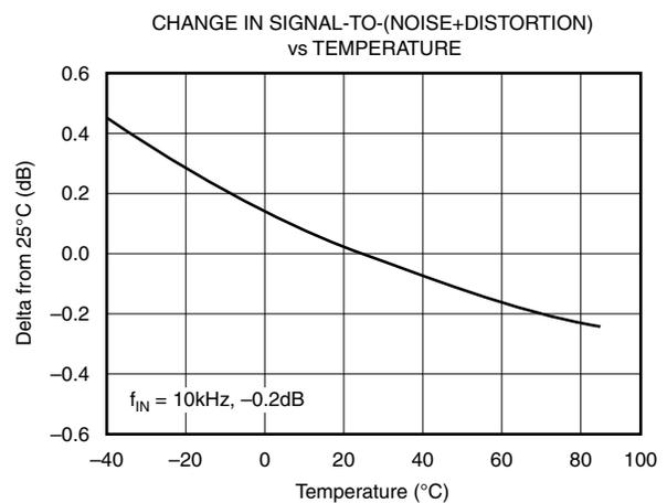
**TYPICAL CHARACTERISTICS,  $V_{CC} = 2.7 V$**
