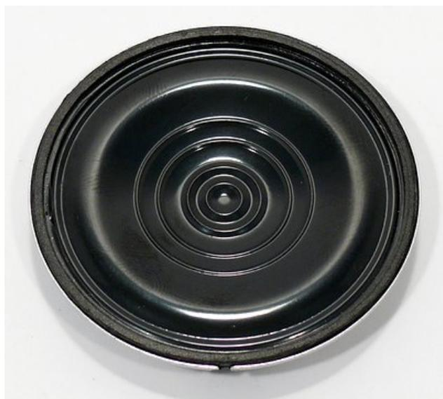
**5,7 cm (2,2") Kleinlautsprecher** mit Kunststoffmembran (Mylar) und Metallkorb. Äußerst flache Bauweise, deshalb geeignet zur Signalausgabe in Geräten und Anlagen, in denen die Einbautiefe beschränkt ist. Der Anschluss erfolgt über rückseitig angebrachte Lötstellen.
