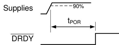
**Figure 6-3. Power-On-Reset Timing**
