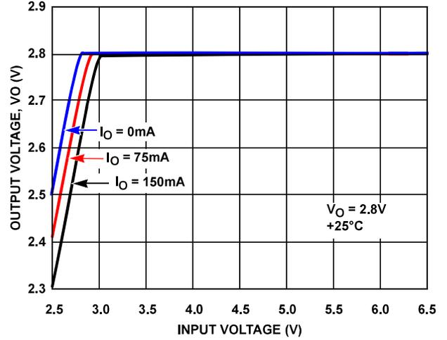
FIGURE 6. DROPOUT VOLTAGE vs INPUT VOLTAGE (2.8V OUTPUT)
