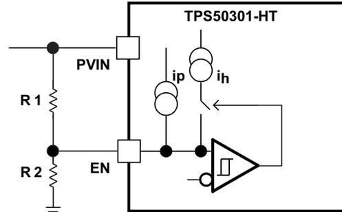
Figure 19. Adjustable PVIN UVLO,  $V_{IN} \geq 3\text{ V}$
