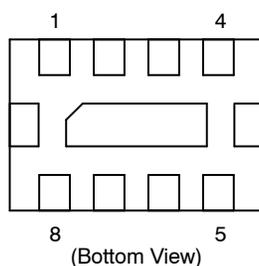
**Figure 3. Pin Diagram**
